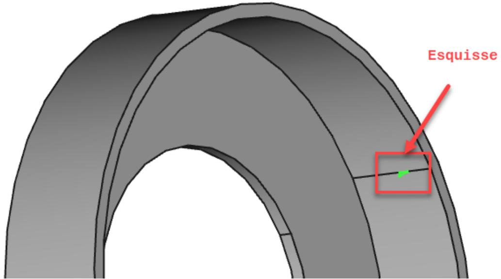
12. Sélectionner l'esquisse et créer une hélice additive
