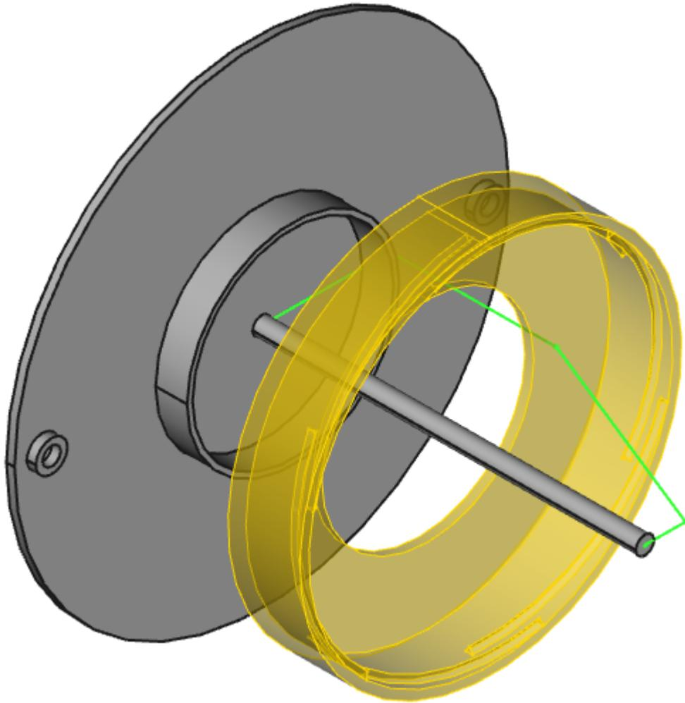
6. Créer un protrusion
